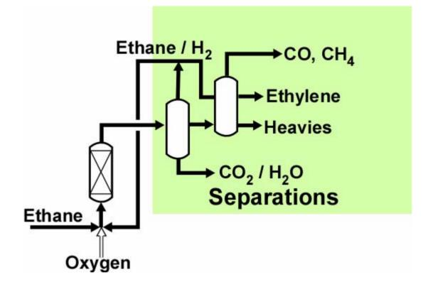
Feed:  $C_2H_6 + O_2$  (Pure) Products:  $C_2H_4 + Heavies + H_2O + CO + CO_2 + CH_4$
